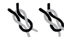
Рисунок 1 - Схема узла шпагата
